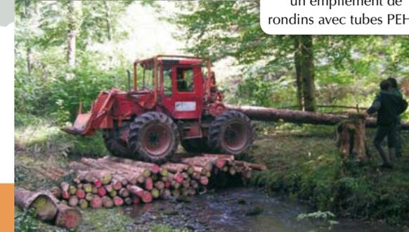
Passage d'un ruisseau sur un empilement de rondins avec tubes PEHD
